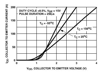
FIGURE 6. COLLECTOR TO EMITTER ON STATE VOLTAGE
