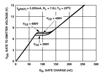
FIGURE 14. GATE CHARGE WAVEFORM
