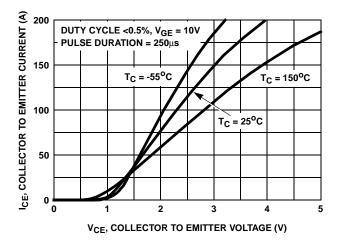
FIGURE 5. COLLECTOR TO EMITTER ON STATE VOLTAGE
